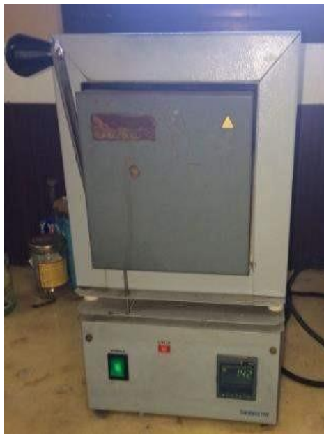
Gambar 16. Proses Pengujian Kadar Abu
