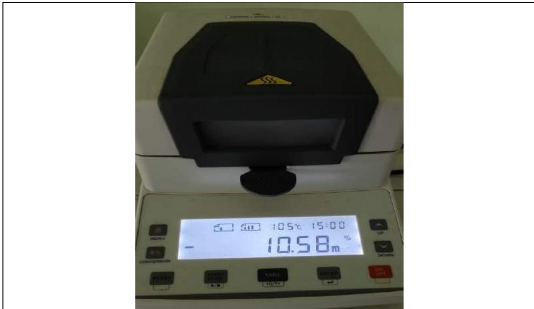
Gambar 15. Kadar Air (dengan alat Halogen Moisture Analyzer )
