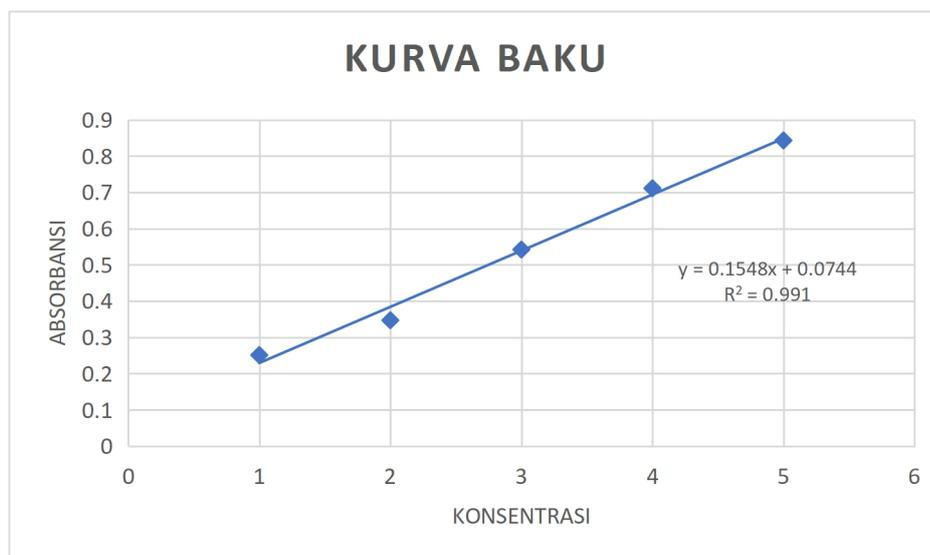
**Gambar 5.1** Hasil Kurva Kalibrasi Larutan Rhodamin-B pada Konsentrasi 1 ppm, 2 ppm, 3 ppm, 4 ppm, dan 5 ppm.
