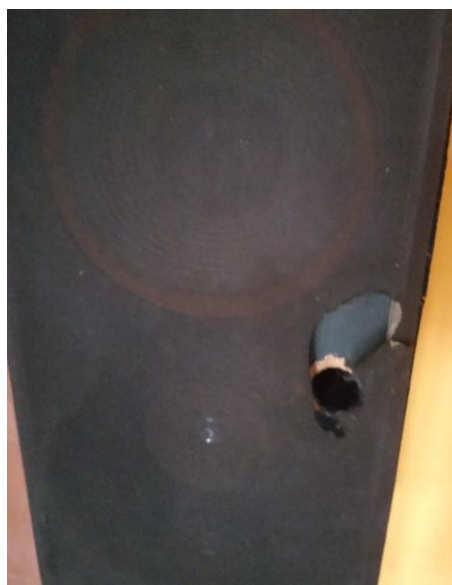
Gambar 6 Bekas gigitan tikus pada pengeras suara
