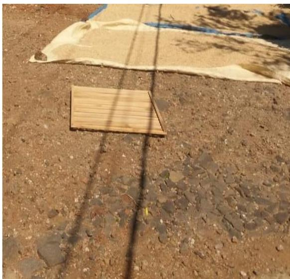
Gambar 6 pengukuran lalat menggunakan *fly grill*
