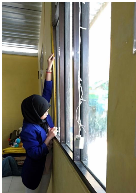
Gambar 3. Pengukuran Luas Ventilasi
